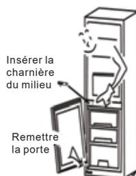
7. Placez la porte du réfrigérateur sur la charnière du milieu, en vous assurant que la goupille de charnière est insérée dans le trou au bas de la porte du réfrigérateur. Ensuite, placez la charnière supérieure, vissez la porte et vissez le boulon, recouvrez le couvercle de charnière gauche et vissez le boulon.
