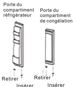
6 . Placez la porte du compartiment de congélation sur la charnière inférieure, en vous assurant que la goupille de la charnière est insérée dans le trou en bas de la porte du réfrigérateur. Remettez la charnière du milieu sur l'appareil, en vous assurant qu'elle soit sur le côté opposé de sa position originale.
