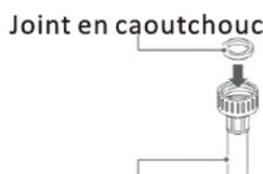
2. Raccordez le tuyau d'alimentation en eau au robinet à la main, puis serrez-le de 2/3 de tour avec une pince.
