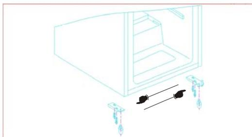
Dévissez la tige supérieure et remettez la sur le côté opposé. Placez la porte sur la tige supérieure et fermez la. Vissez le support sur le côté opposé.
