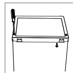
13. Détacher les joints des portes du réfrigérateur puis fixez-les après inversion.
