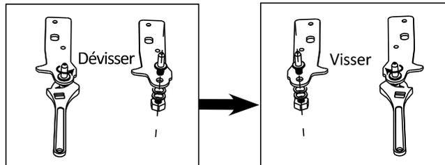
10. Remettez le support en place en le fixant à l'axe de la charnière inférieure. Remplacer les deux pieds réglables.
