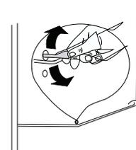
Assurez-vous que le trou d'évacuation du réfrigérateur, situé derrière l'appareil, reste bien dégagé en permanence.
