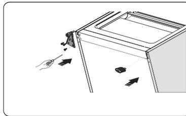
12. Transférez la porte inférieure sur la position de propriété, ajustez la partie inférieure de la charnière, faites rentrer l'axe de charnière dans le trou inférieur de la porte inférieure, puis serrez les boulons.
