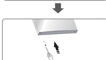
9. Changer de gauche à droite les couvercles des trous de vis sur la plaque de recouvrement centrale (comme indiqué sur la figure cidessous).
