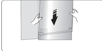
15. Transférez la partie supérieure de la charnière et faites rentrer l'axe de la charnière supérieure dans le trou supérieur de la porte supérieure, et ajustez la position de la porte supérieure (veuillez soutenir la porte supérieure avec la main), en fixant la partie supérieure de la charnière avec les vis autotaraudeuses spéciales à bride.
