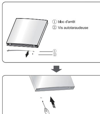
7. Dévisser les deux vis autotaraudeuses spéciales à bride qui servent à fixer la partie centrale de la charnière, puis retirer la partie centrale qui maintient la porte inférieure en place.
