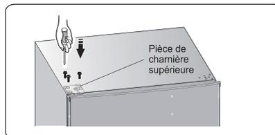
16. Installez le couvercle du trou de vis dans le coin supérieur droit du réfrigérateur. Installez le couvercle supérieur de la charnière (qui se trouve dans le sac en plastique) dans le coin gauche. Mettez l'autre couvercle supérieur de charnière dans le sac en plastique.
