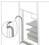
3. Ouvrez la porte et poussez l'appareil contre le côté du meuble de cuisine opposé de manière à ce que l'appareil soit bien encasté. Sécurisez avec les 6 vis fournies dans le kit inclus avec l'appareil. Fermez la grille de ventilation (D) si elle est fournie) et faites pivoter le couvercle (D) en position.
