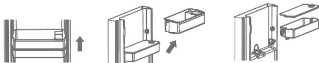
2. Après le nettoyage, repositionnez le réservoir d'eau, le couvercle et le balcon du réservoir comme décrit ci-dessous.
