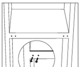
11. Relevez l'appareil et placez la porte sur la charnière inférieure. Assurez-vous que le noyau de charnière inférieure est inséré dans le trou de la porte. Déplacez ensuite le couvercle du trou de charnière de la porte inférieure du côté gauche vers le côté droit.
