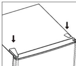
15. Détacher les joints des portes du réfrigérateur et du congélateur puis fixez-les après inversion.
