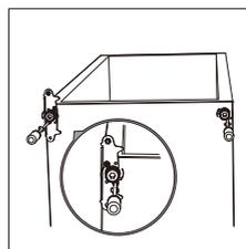
9. Inversez la charnière centrale 180°C et transférez-le vers la position gauche. Remontez la goupille de la charnière centrale dans le trou supérieur de la porte inférieure, puis serrez les boulons.
