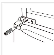
10. Remontez la porte supérieure en place. Alignez la porte horizontalement et verticalement afin que le joint soit bien fermé de tous les côtés, puis insérez la charnière et vissez-la sur la partie supérieure de l'appareil.
