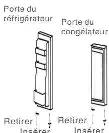
6. Placez la porte du congélateur sur la charnière inférieure, en s'assurant que la goupille de charnière est insérée dans le trou en bas de la porte du congélateur. Refixez la charnière du milieu sur l'appareil, en s'assurant qu'il est au côté opposé par rapport à sa position originale.
