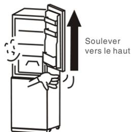
3. Démontez la charnière du milieu à l'aide d'un tournevis. Soulevez la porte vers le haut pour la dégager de la charnière inférieure. Retirez la porte et déposez-la doucement sur une surface rembourrée.
