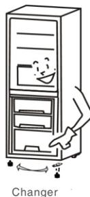
5. Retirez la goupille de charnière qui se trouve dans le bas des portes du réfrigérateur et du congélateur. Insérez la goupille de charnière de remplacement qui est fournie avec l'appareil à l'autre côté de la porte.
