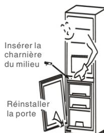
7. Placer la porte du réfrigérateur sur la charnière du milieu, en s'assurant que la goupille de charnière est insérée dans le trou en bas de la porte du réfrigérateur. Réinstaller le couvercle supérieur de l'avant à l'arrière, insérer les boulons et visser-les à l'arrière du couvercle supérieur.
