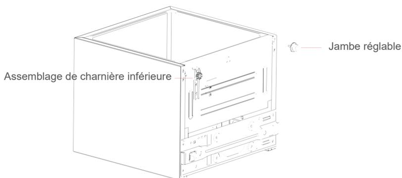
6) Mettez la porte sur la charnière inférieure verticalement, et validez l'étanchéité au gaz de la porte joint, puis installer la charnière supérieure par des vis de montage et le couvercle de la charnière, enfin couvrir les bouchons de trou sur le côté supérieur droit.
