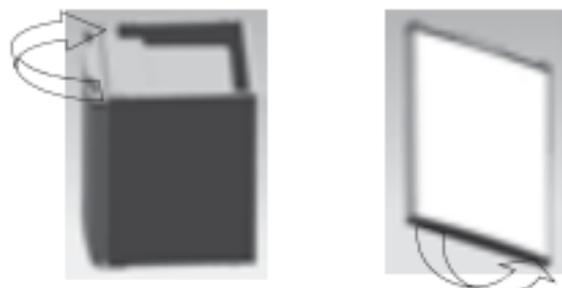
Réinstallez la charnière supérieure. Réinstallez la butée et le coussinet de la porte.
