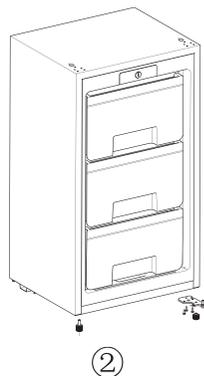
Retirez les trois vis fixant la charnière inférieure du côté droit. Retirez la charnière supérieure et desserrez le pied ajustable en bas de la charnière inférieure. En même temps, retirez les vis fixant les axes de charnières avec une clé et desserrez les axes de charnières inférieures. Retirez le pied ajustable du côté gauche inférieur.
