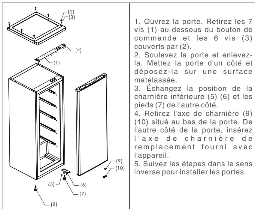
1. Ouvrez la porte. Retirez les 7 vis (1) au-dessous du bouton de commande et les 6 vis (3) couverts par (2).
