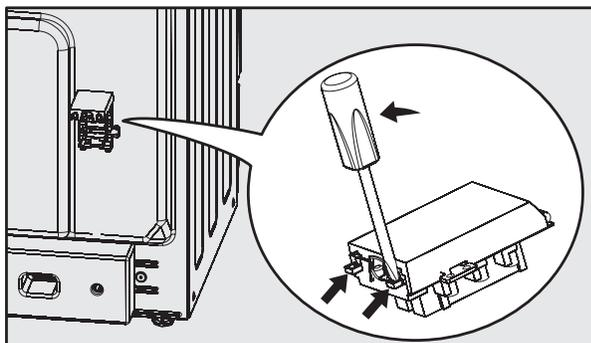
2. Connectez à l'électricité selon le schéma imprimé sur la surface du couvercle.
