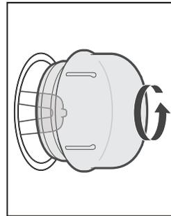
**AVERTISSEMENT:** Afin d'éviter les chocs électriques, assurez-vous que l'appareil soit débranché du réseau électrique et qu'il soit refroidi complètement avant de retirer la lentille de l'ampoule.
