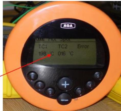
La télécommande SNIFFER permet d'obtenir les erreurs et les températures des thermocouples
