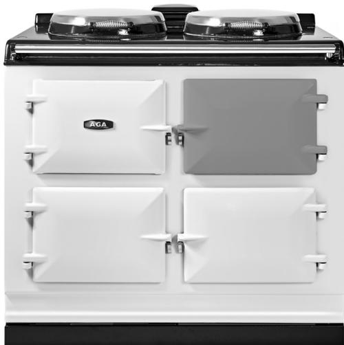
Le four à rôtir est chauffé indirectement par deux éléments, un à la base du four et l'autre dans la partie supérieure. Cet élément chauffe l'air et la fonte à l'intérieur afin de fournir des résultats de cuisson similaires à ceux de la cuisinière à accumulation de chaleur traditionnelle de l'AGA, avec la possibilité de pouvoir l'éteindre pour changer la température de cuisson.
