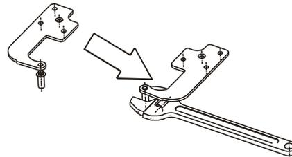
4. Déplacez l'interrupteur de porte du cache de la charnière de porte droite vers le cache de la charnière gauche situé dans le sac des pièces.
