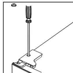
14. Remplacez la porte supérieure en veillant à ce qu'elle soit alignée avec le corps. Fixez le cache.
