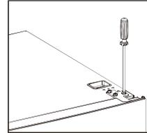
3. Ajustement de la position du noyau de la charnière inférieure et de la charnière supérieure à la position opposée
