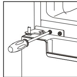
13. Remplacez la porte supérieure en veillant à ce qu'elle soit alignée avec le corps de l'appareil, afin que le joint permette de fermer hermétiquement la porte. Fixez ensuite la porte en vissant bien la charnière supérieure.
