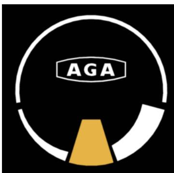
Fig. 3 La couleur ambre indique un réglage de température basse. (L'évolution sera également vue dans ce paramétrage).
