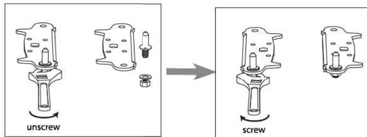
7. Remontez le support en installant l'axe de charnière inférieur. Remplacez les deux pieds réglables. Transférez la porte inférieure à la position de propriété.
