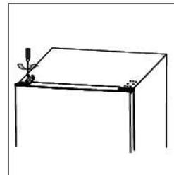
14. Fixez le couvercle de la charnière à gauche et le couvercle du trou de la charnière à droite.
