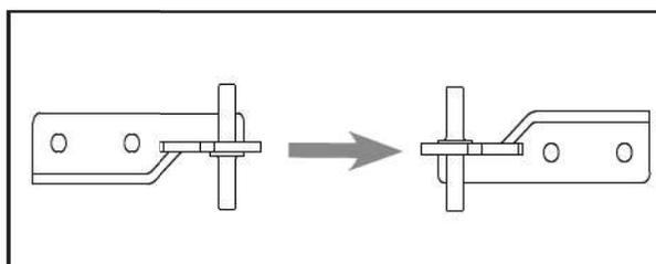
10. Remettez la porte supérieure en place. Assurez-vous que la porte est alignée horizontalement et verticalement afin que le joint soit fermé de tous les côtés avant de finalement serrer la charnière supérieure. Puis inertez la charnière et vissez-la à l'avant de l'appareil.
