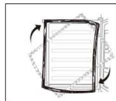
9. Faites en sorte que la charnière centrale inverse la direction 180C, puis transférez-la dans la position de propriété gauche. Faites l'axe de charnière du milieu dans le trou supérieur de la porte inférieure, puis serrez les boulons.
