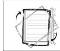
10. Inversez la charnière centrale à 180°, puis transférez-la dans la bonne position sur le côté gauche. Placez l'axe de charnière du milieu dans le trou supérieur de la porte inférieure, puis serrez les boulons.
