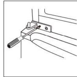
11. Remettez la porte supérieure en place. Assurez-vous que la porte est alignée horizontalement et verticalement afin que le joint soit fermé de tous les côtés avant de serrer définitivement la charnière supérieure. Inversez ensuite la charnière et vissez-la sur le dessus du meuble.
