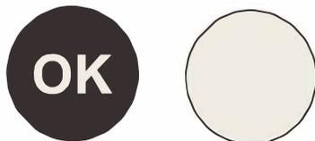
Pour la bonne conservation des denrées dans votre réfrigérateur et notamment dans la zone la plus froide, veillez à ce que dans l'indicateur de température apparaisse « OK ». Si « OK » n'apparaît pas, la température moyenne de la zone est trop élevée. Réglez le thermostat sur une position supérieure.
