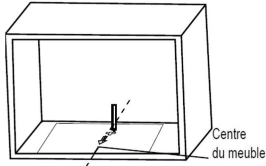
2 - Enlever le gabarit, installer la plaque d'installation et utiliser les deux petites vis pour fixer la plaque dans le meuble au niveau des marques.
