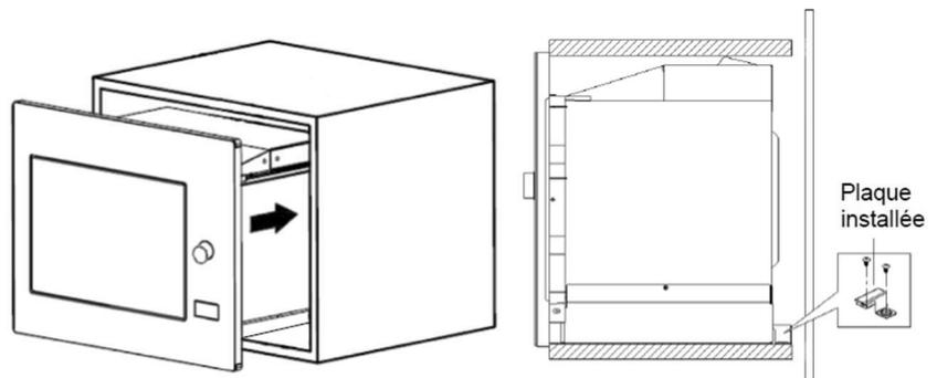
4 - Ajuster la façade du four aux parois du meuble. Une fois l'appareil positionné correctement, utiliser la grande vis pour fixer l'appareil à l'avant du meuble.
