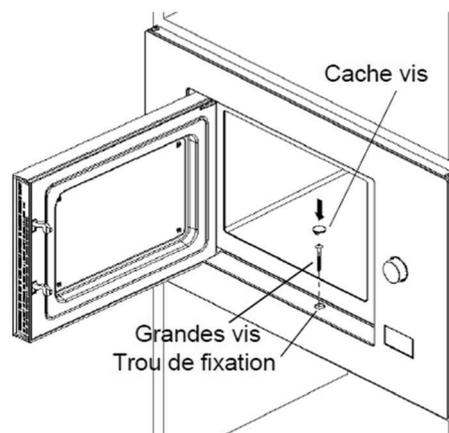
5 - Enfin installer le cache-vis sur le trou de fixation
