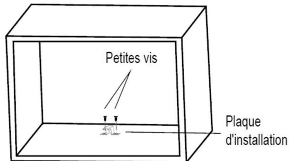
3 - Insérer le micro-ondes dans la niche et s'assurer que l'arrière est bien inséré dans la paque afin que l'appareil ne bascule pas. S'assurer que le câble d'alimentation n'est pas coincé sous l'appareil.
