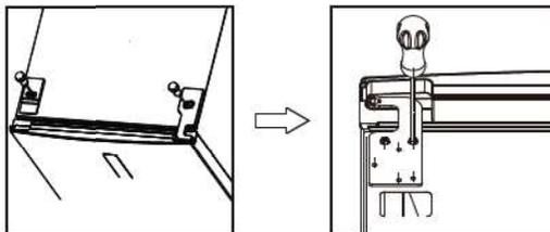
2. Déballez le panneau en plastique et retirez la gaine du fil à l'aide d'un tournevis plat. Faites attention au fil qui se trouve à l'intérieur. Positionnez le fil et son connecteur de l'autre côté. Installez la gaine du fil de l'autre côté et remettez le bandeau.
