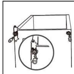
7. Dévissez la douille intermédiaire droite avec son bloc métallique du bas de la porte supérieure. Montez ensuite la douille intermédiaire gauche avec son bloc métallique du côté gauche du bas de la porte supérieure. (Même opération que pour la porte inférieure.)
