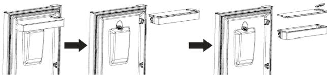
2. Après le nettoyage, repositionnez le réservoir d'eau, le couvercle et le bac du réservoir comme indiqué ci-dessous.
