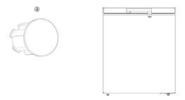
Apré s le couvercle de la poigné e assemblé sur la porte, fixez la couvercle 4 sur le couvercle de la poigné e.
