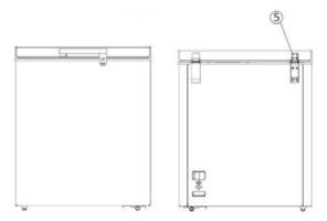
Si l'anneau de blocage ne maintient pas le loquet pendant l'installation de la poignée, dévissez les vis à tête ronde (5) sur l'arrière de la porte et ajustez la position de la porte en hauteur puis finissez de visser la porte.
