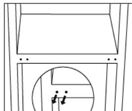
7. Allongez-vous à l'arrière de l'armoire sur un coussin souple. Et dévissez la charnière inférieure et le pied de mise à niveau.
