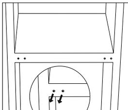
11. Allongez-vous à l'arrière de l'armoire sur un coussin souple. Et dévissez la charnière inférieure et le pied de mise à niveau.
