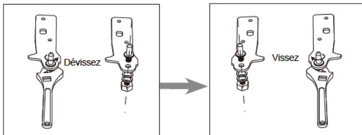
9. Installez la charnière du côté gauche et la base du pied du côté droit. Vissez ensuite deux pieds de mise à niveau avec leurs pièces d'origine.
