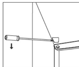
4. Déplacez le couvercle du noyau du côté gauche vers le côté droit. Ensuite, soulevez la porte supérieure et placez-la sur une surface rembourrée pour l'empêcher de se rayer.
