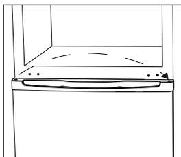
12. Relevez l'appareil et placez la porte sur la charnière inférieure. Assurez-vous que le noyau de charnière inférieur est inséré dans le trou de la porte. Déplacez ensuite le couvercle du trou de charnière de la porte inférieure du côté gauche vers le côté droit.
