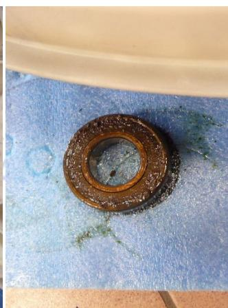
Scoateți rulmentul exterior folosind extractorul de rulmenți. Poziționați semirezervorul pe 2 cleme de lemn pentru a nu-l deteriora.
