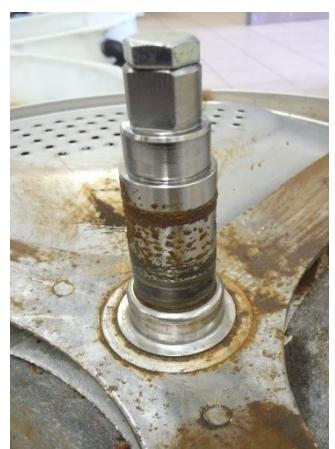
Kriechöl auf das Querstück auftragen und einige Minuten einwirken lassen. Legen Sie die Schuhplatte auf die Riemenscheibenschraube und schlagen Sie mit dem Hammer, um die Trommel zu entfernen.
