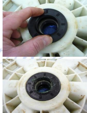
Positionner le roulement intérieur, frapper pour l'enfoncer en butée du moyeu: lors de la frappe le bruit "sourd" devient "métallique".
