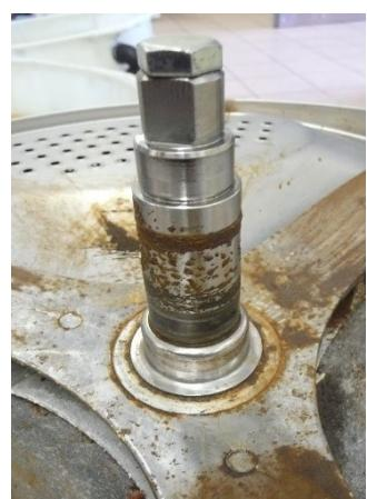
Aplicați ulei penetrant pe traversă și lăsați să acționeze câteva minute. Așezați clema pe șurubul scripetelui, loviți cu ciocanul pentru a scoate tamburul.
