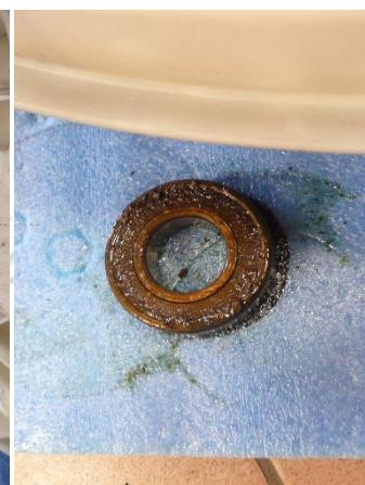
Zdejmij łożysko zewnętrzne za pomocą ściągacza do łożysk. Półziornik umieść na 2 drewnianych knagach, aby go nie uszkodzić.
