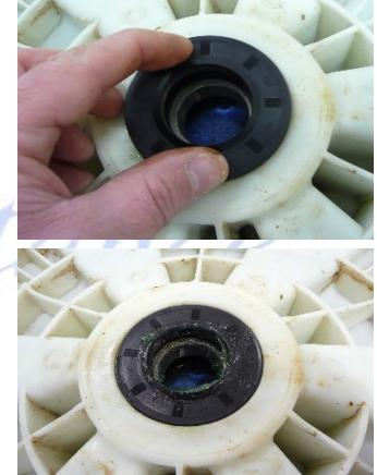
Helyezze el a belső csapágyat, kopogtassa, hogy az agyhoz nyomja: kopogáskor a "tompa" zaj "fémessé" válik.
