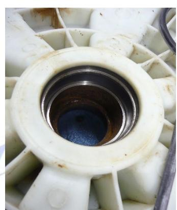
După modificarea diametrului discului, poziționați poansonul lagărului pentru a extrage atât rulmentul interior, cât și etansarea.
