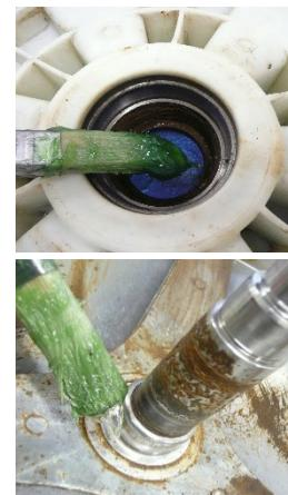
Vuelva a colocar el sello del tanque para evitar fugas de agua.
