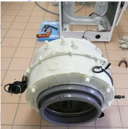
Entfernen Sie die Achsen von den Stoßdämpfern und entfernen Sie den Schlauch auf Höhe der Laugenpumpe.
