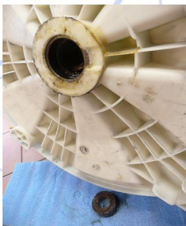
Retire el cojinete exterior con el extractor de cojinetes. Coloque el medio tanque sobre 2 listones de madera para no dañarlo.
