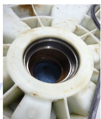
Po zmianie średnicy tarczy umieść stempel łożyska, aby wyjąć zarówno łożysko wewnętrzne, jak i uszczelkę olejową.
