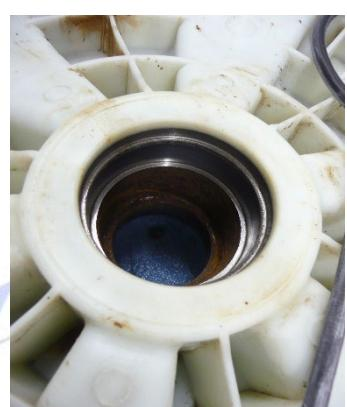
Después de cambiar el diámetro del disco, coloque el punzón del cojinete para extraer tanto el cojinete interior como el sello de aceite.
