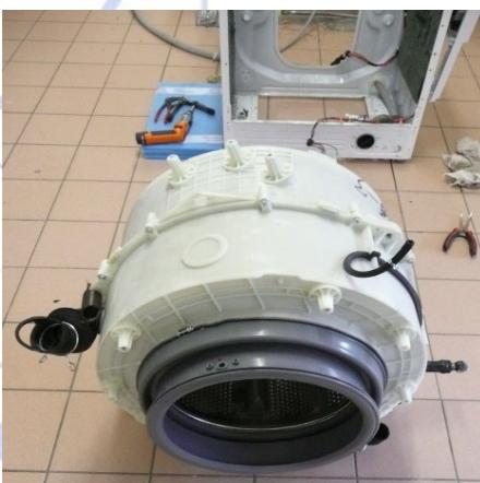
Wyjmij osie z amortyzatorów i wyjmij wąż na poziomie pompy spustowej.
