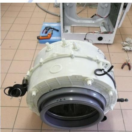
Távolítsa el a tengelyeket a lengéscsillapítókról, és távolítsa el a tömlöt a leeresztő szivattyú szintjén.
