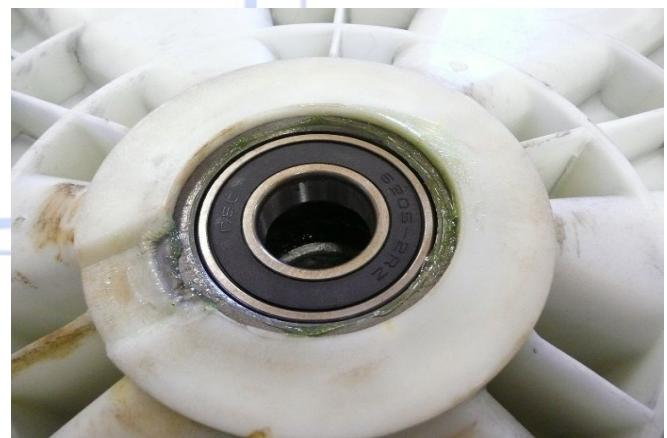
Positionner le roulement extérieur, frapper pour l'enfoncer en butée du moyeu: lors de la frappe le bruit "sourd" devient "métallique".
