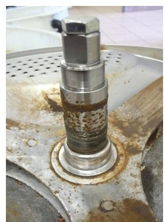
Nałóż olej penetrujący na poprzeczkę i pozostaw na kilka minut. Umieść knagę na śrubie koła pasowego, uderz młotkiem, aby wyjąć bęben.
