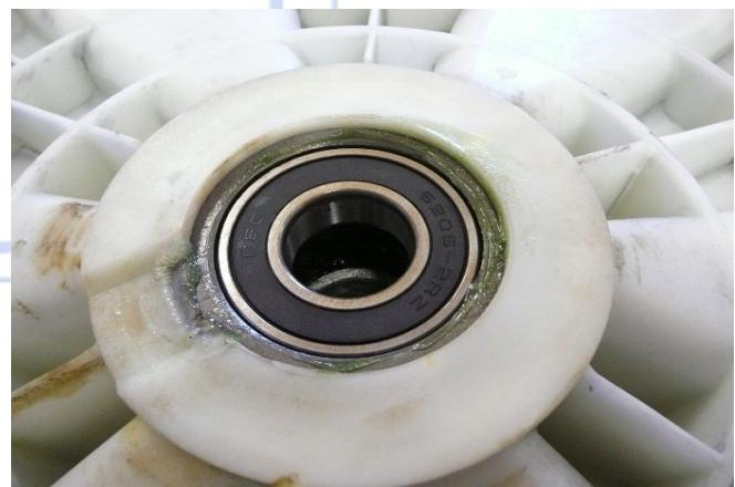
Außenlager positionieren, durch Klopfen gegen die Nabe drücken: Beim Klopfen wird das „dumpfe“ Geräusch „metallisch“.
