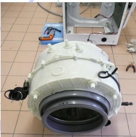
Retire los ejes de los amortiguadores y retire la manguera al nivel de la bomba de drenaje.
