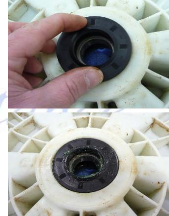
Innenlager positionieren, durch Klopfen gegen die Nabe drücken: Beim Klopfen wird das „dumpfe“ Geräusch „metallisch“.
