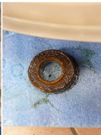
Entfernen Sie das äußere Lager mit dem Lagerabzieher. Positionieren Sie den halben Tank auf 2 Holzklampen, um ihn nicht zu beschädigen.
