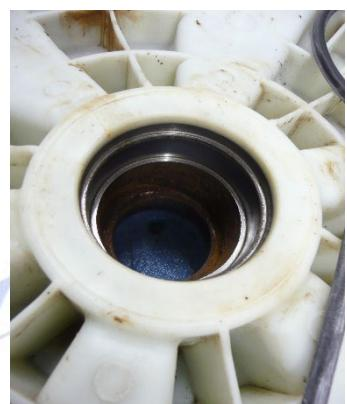
Positionieren Sie nach dem Ändern des Scheibendurchmessers den Lagerstempel, um sowohl das innere Lager als auch die Oldichtung herauszuziehen.
