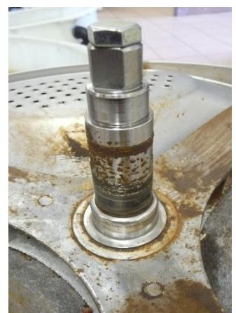
Aplicar aceite penetrante en el travesaño y dejar actuar unos minutos. Coloque la abrazadera en el tornillo de la polea, golpee con el martillo para quitar el tambor.
