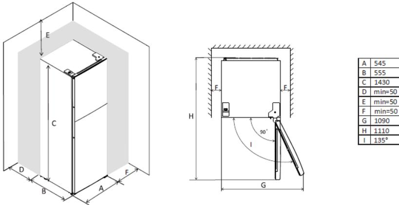
Placez votre appareil sur une surface plane et stable. Mettez à niveau à l'appareil si besoin ; pour cela ajuster les pieds situés à l'avant de l'appareil. Si l'appareil n'est pas installé de niveau, les portes et joints magnétiques ne seront pas alignés correctement.
