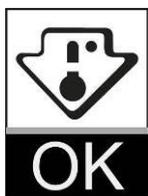
Si la couleur de l'indicateur est blanche, cela signifie que la température est trop élevée, il faut dans ce cas augmenter le réglage du thermostat et attendre 12 heures pour effectuer un nouveau contrôle visuel de l'indicateur. Après chargement ou ouverture de la porte, il est normal que l'indicateur devienne blanc au bout de quelques instants.
