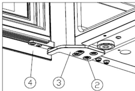
Faire pivoter la porte ④ à 180 degrés et insérer la charnière supérieure droite du sachet de pièces ⑤, visser à fond les vis M5\*16 ②.
