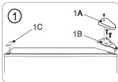
Entfernen Sie die Kühlschranktür. Versetzen Sie den Stopfen (2) der Kühlschranktür von der oberen linken Seite auf die obere rechte Seite.
