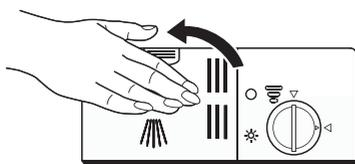
3. Fermez le couvercle et appuyez dessus jusqu'à ce qu'il se verrouille en place.
