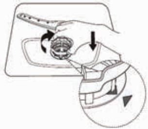
Remontez les filtres dans l'ordre inverse du démontage, remettez l'insert du filtre et tournez-le dans le sens des aiguilles d'une montre vers la flèche indiquant la fermeture.
