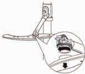
Pour démonter le bras de lavage supérieur, immobilisez l'écrou et tournez le bras dans le sens des aiguilles d'une montre pour le retirer.
