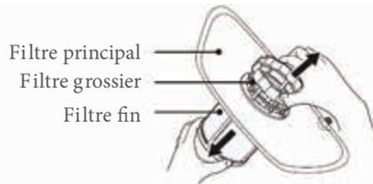
Le filtre fin peut être retiré du bas du dispositif de filtration. Le filtre dégrossisseur peut être détaché du filtre principal en appuyant délicatement sur les pattes de la partie supérieure et en le retirant.
