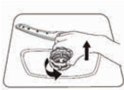
Tenez le filtre dégrossisseur et tournez-le dans le sens inverse des aiguilles d'une montre pour déverrouiller le filtre. Soulevez le filtre et retirez-le du lave-vaisselle.
