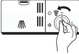
1. Enlevez le bouchon du réservoir de liquide de rinçage en le tournant dans le sens inverse des aiguilles d'une montre.
