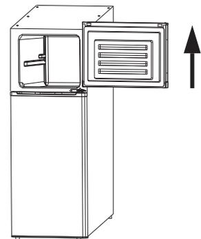
3. Démontez la charnière du milieu à l'aide d'un tournevis. Soulevez la porte vers le haut pour la dégager de la charnière inférieure. Retirez la porte et déposez-la doucement sur une surface rembourrée.
