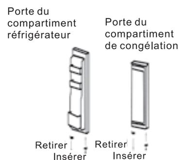
6. Placez la porte du compartiment réfrigérateur sur la charnière inférieure, en vous assurant que la goupille de la charnière est insérée dans le trou en bas de la porte du réfrigérateur. Remettez la charnière du milieu sur l'appareil, en vous assurant qu'elle soit sur le côté opposé de sa position originale.
