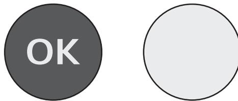
Pour la bonne conservation des denrées dans votre réfrigérateur et notamment dans la zone la plus froide, veuillez à ce que dans l'indicateur de température apparaisse « OK ». Si « OK » n'apparaît pas, la température moyenne de la zone est trop élevée. Réglez le thermostat sur une position supérieure.
