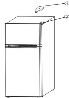
2. Soulevez la porte vers le haut pour la dégager de la charnière du milieu. Retirez la porte et déposez-la doucement sur une surface rembourrée.
