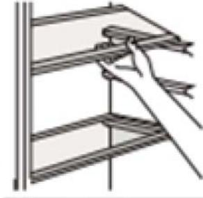
In die Innenwände des Kühlschranks sind mehrere Laufschienen eingearbeitet, sodass die Regalböden nach Wunsch versetzt werden können.
