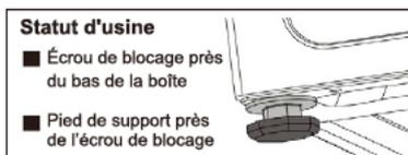
**!** **Remarque:** afin de faciliter l'installation, l'état d'usine du pied peut ne pas être entièrement verrouillé, veuillez vous assurer de verrouiller les quatre pieds avant d'ajuster le niveau!
