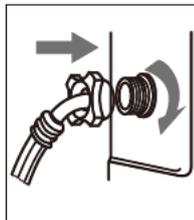
2. Connectez l'autre extrémité du tuyau d'arrivée à la soupape d'entrée à l'arrière du lave-linge et serrez fermement le tuyau dans le sens des aiguilles d'une montre.
