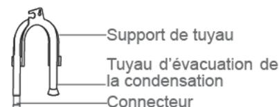
tuyau d'évacuation direct peut être installé directement sur ce modèle sans l'utilisation du connecteur.
