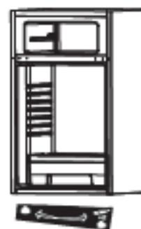
5. Retirez la goupille de la charnière qui se trouve dans le bas des portes du réfrigérateur et du compartiment de congélation. Insérez la goupille de la charnière de remplacement qui est fourni avec l'appareil à l'autre côté de la porte.
