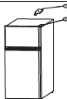
2. Soulevez la porte vers le haut pour la dégager de la charnière du milieu. Retirez la porte et déposez-la doucement sur une surface rembourrée.
