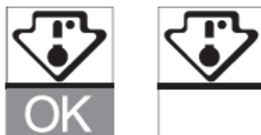
Pour la bonne conservation des denrées dans votre réfrigérateur et notamment dans la zone la plus froide, veuillez à ce que dans l'indicateur de température apparaisse « OK ». Si « OK » n'apparaît pas, la température moyenne de la zone est trop élevée. Réglez le thermostat sur une position supérieure.
