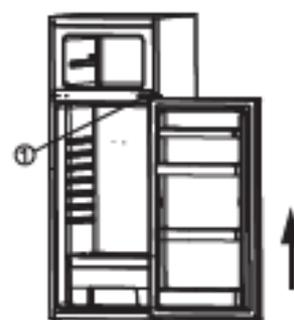
4. Changez la position de la charnière inférieure et le pied réglable de l'autre côté de l'appareil.
