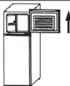
3. Démontez la charnière du milieu à l'aide d'un tournevis. Soulevez la porte vers le haut pour la dégager de la charnière inférieure. Retirez la porte et déposez-la doucement sur une surface rembourrée.
