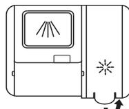
2. Versez le produit de rinçage dans le compartiment, en veillant à ne pas trop le remplir.
