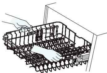
1. Pour remonter le panier supérieur, il suffit de le soulever en plaçant les mains au milieu de chaque côté, jusqu'à ce que le panier s'enclenche en position haute. Il n'est pas nécessaire de soulever les poignées de réglage.
