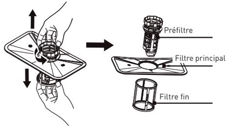
3. Les gros restes d'aliments peuvent être éliminés en rinçant le filtre sous l'eau courante. Pour un nettoyage plus approfondi, utilisez une brosse de nettoyage douce.
