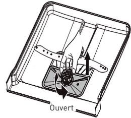
2. Tirez le filtre fin vers le bas pour le désolidariser du groupe filtre. Le préfiltre peut être séparé du filtre principal en appuyant doucement sur les languettes en haut du filtre et en tirant sur le filtre pour l'extraire.
