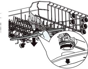
Pour retirer le bras de lavage supérieur, maintenez immobile l'écrou central et faites tourner le bras de lavage dans le sens inverse des aiguilles d'une montre pour le libérer.
