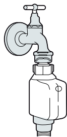
tubo de suministro de seguridad
