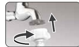
Raccordez le tuyau d'arrivée d'eau à la vanne d'arrivée d'eau et à un robinet d'eau froide, de la manière indiquée dans l'illustration.
