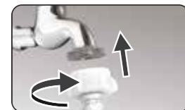
Conecte el tubo de suministro de agua a la válvula de entrada de agua y a una toma de agua fría, tal y como se indica.
