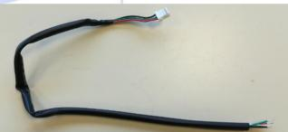
3 - Passer le câble dans la douille de charnière et placer la gaine thermorétractable (non fournie) avant de souder les fils en respectant les couleurs.
