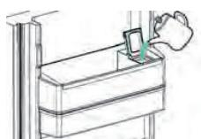
2. Llene el depósito de agua con agua potable hasta la línea de 3 l.
