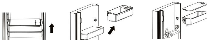
2. Plaats na het reinigen het waterreservoir, het deksel en de bovenrand van het reservoir opnieuw zoals hieronder beschreven.
