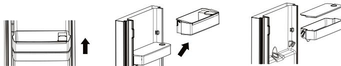
2. Una vez limpio, vuelva a colocar el depósito de agua, la tapa y el estante del depósito, tal y como se indica a continuación.
