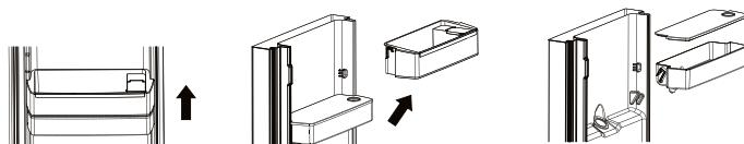
2. Une fois les éléments nettoyés, repositionnez le réservoir d'eau, le couvercle et le balconnet du réservoir, en suivant les indications ci-dessous.
