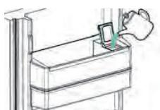
2. Remplissez le réservoir avec de l'eau potable à hauteur du marquage indiquant 3 l.
