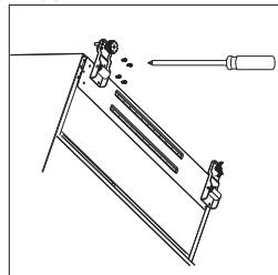
6. Nadat het toestel op zijn plaats staat, monteren de deuren in omgekeerde volgorde.
