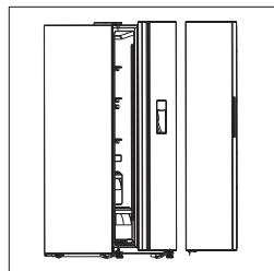
5. Schroef de onderste scharnieren los.
