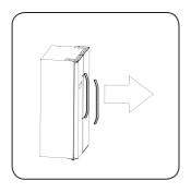
• Une fois l'appareil en place, installez à nouveau les poignées en suivant la procédure inverse.
