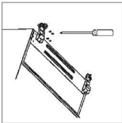
6. Une fois l'appareil en place, installez à nouveau les portes en suivant la procédure inverse.
