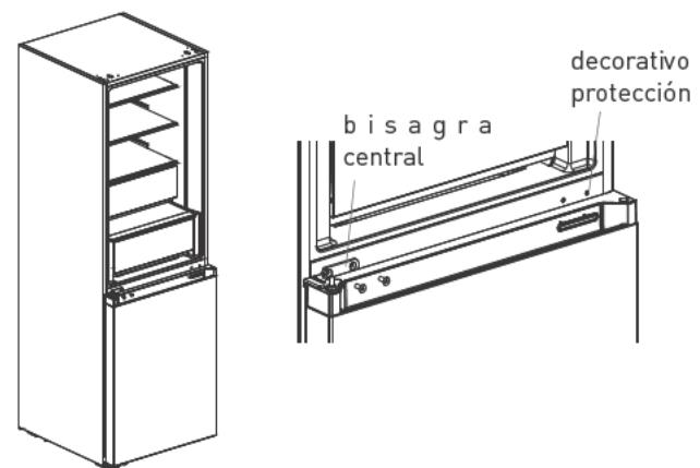
8. Saque el cubre bisagra superior izquierdo y la bisagra superior izquierda de la bolsa de accesorios. Coloque la puerta en la bisagra central e instale la bisagra superior izquierda. Conecte la línea de señal superior del frigorífico ④ a la línea de señal del cuerpo de la puerta ①, y conecte la línea de señal ② a la línea de señal ③. Por último, vuelva a colocar el cubre bisagra en el lado derecho.
