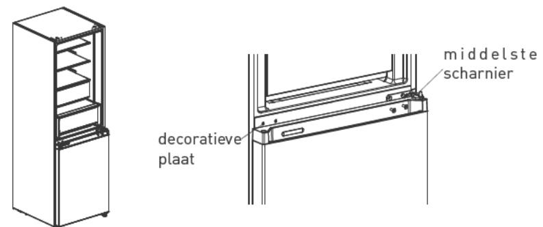
4. Verwijder de diepvriesdeur van de behuizing (zorg ervoor dat u geen kleine onderdelen verliest, zoals de asbus en de deurstop);
