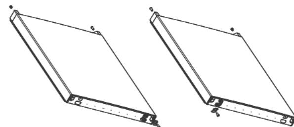
7. Instale la puerta del congelador en la bisagra inferior. A continuación coloque la bisagra central y cubra el agujero de la bisagra con el embellecedor.
