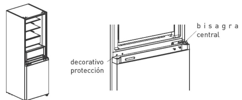
4. Retire la puerta del congelador (con cuidado de no perder las piezas pequeñas, como el casquillo del eje y el tope de la puerta); Retire la bisagra y ajuste el ángulo. Retire e instale el eje de la bisagra inferior en el otro lado, e instale la bisagra inferior ya modificada en el otro lado de la estructura.
