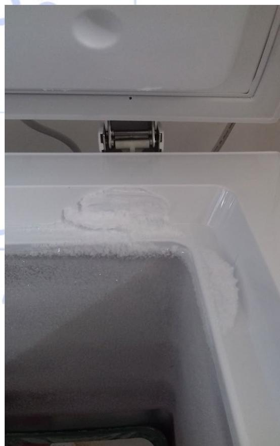
A fedél nyitásának megkönnyítése érdekében a tömítés a zsanérok szintjén perforált. Ez kismértékű dérképződést eredményezhet a készülék házában vagy fedelén. **Ez a fagy teljesen normális jelenség, ezért rendszeresen el kell távolítani, hogy ne zavarja a fedél zárását.**
