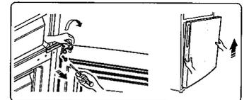
7. Placez la porte inférieure sur une surface lisse avec ses panneaux verticaux. Des vis mal serrées ③ la partie détachée ② et la partie ①. Tournez la partie ① de 180°, puis installez ① et la partie ② dans la position correspondante sur le côté gauche avec des vis ③.
