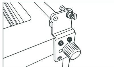
6. Retirez la goupille de la position 1 et remplacez-la à la position 2. Placez la charnière du côté opposé de l'armoire, fixez-la avec trois boulons, vissez le pied en place.
