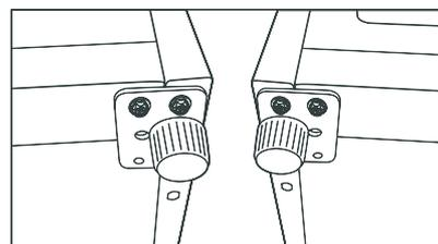
8. Si le joint de la porte ne coïncide pas avec l'armoire, de n'importe quel côté, chauffez le joint avec de l'eau chaude et pincez-le en place. Vous pouvez faire cela avec un sèche cheveux mais vous devez veiller à ne pas trop chauffer ou brûler le joint ou vos mains. Veillez à ce que la porte soit alignée horizontalement et verticalement et que le joint soit fermé de tous les côtés avant de serrer les boulons de la charnière. Remplacez le coffre et les vis.
