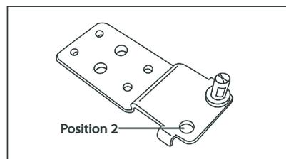
7. Placez la plaque de fixation du côté opposé de l'appareil, fixez-la avec les trois Boulons et vissez le pied en place.
