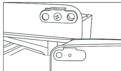
5. Faites basculer l'arrière du congélateur, à 45° maximum, pour accéder à la charnière du fond et aux pieds. Retirez les pieds et les boulons fixant la plaque de la charnière droite et la plaque de fixation gauche.
