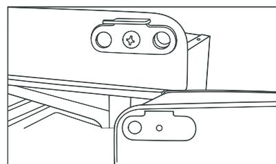
5. Faites basculer l'arrière du congélateur, à 45° maximum, pour accéder à la charnière du fond et aux pieds. Retirez les pieds et les boulons fixant la plaque de la charnière droite et la plaque de fixation gauche.
