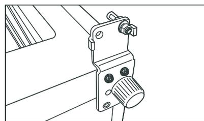
6. Retirez la goupille de la position 1 et remplacez-la à la position 2. Placez la charnière du côté opposé de l'armoire, fixez-la avec trois boulons, vissez le pied en place.
