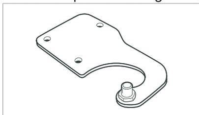
3. Retirez la goupille de la fixation et remplacez-la dans le même trou de l'autre côté.
