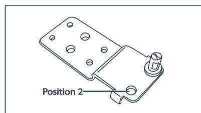
7. Placez la plaque de fixation du côté opposé de l'appareil, fixez-la avec les trois Boulons et vissez le pied en place.
