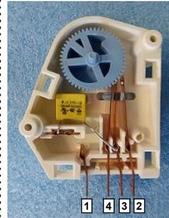
Vue intérieur des lamelles de contacts et du condensateur de 100 nF (monté en série avec le moteur)
