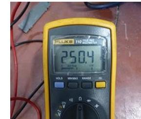
**Mesure de l'état du thermostat de dégivrage depuis l'arrière de l'appareil**
