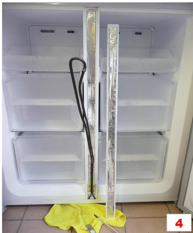
Une fois la traverse retirée, positionner "la boucle de gaz d'air chaud" vers le bas pour sortir l'ensemble et accéder au carter de ventilation.
